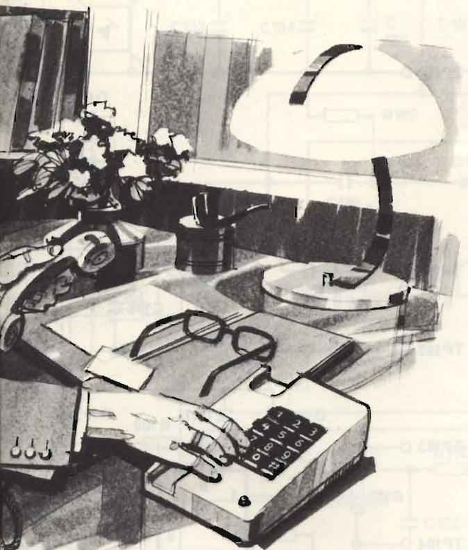
Quando è finito il messaggio registrato, sul medesimo nastro si presenta un segnale audio che avverte il vostro interlocutore che può parlare, e che causa l'arresto del riproduttore e la partenza del registratore.
