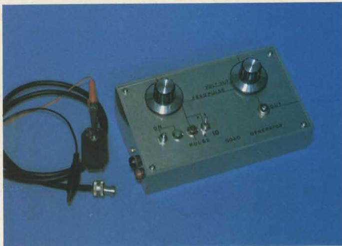
Generatore di stimoli elettrici a realizzazione ultimata. La sonda visibile a fianco va applicata al vegetale in esame.
