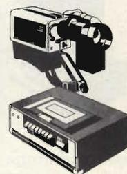
Il sistema BCN della Bosch Fernesh utilizza due testine video e la tecnica di scansione segmentata: un intero quadro televisivo viene registrato in sei segmenti; il rapporto linee/segmenti è di 52.
