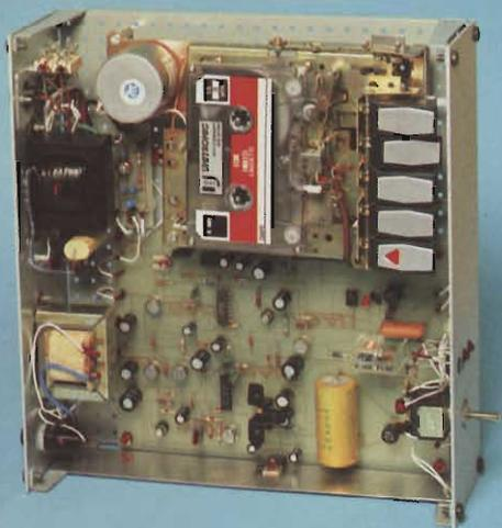
Dopo circa 5 secondi, che corrispondono a tre trilli di telefono, il transistor UJT TR103 genera un impulso sulla resistenza R106 che, dopo essere adattato da due porte NAND dell'integrato IC104, entra nel pin della memoria formata da IC103, che si setta.
