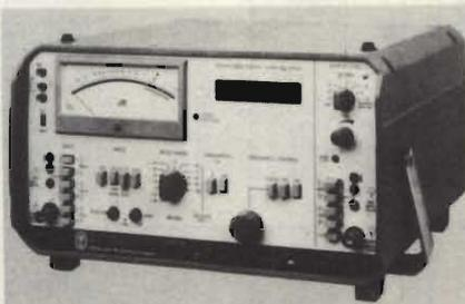
Misuratore di livello per il range da 200 Hz a 1,62 MHz.
